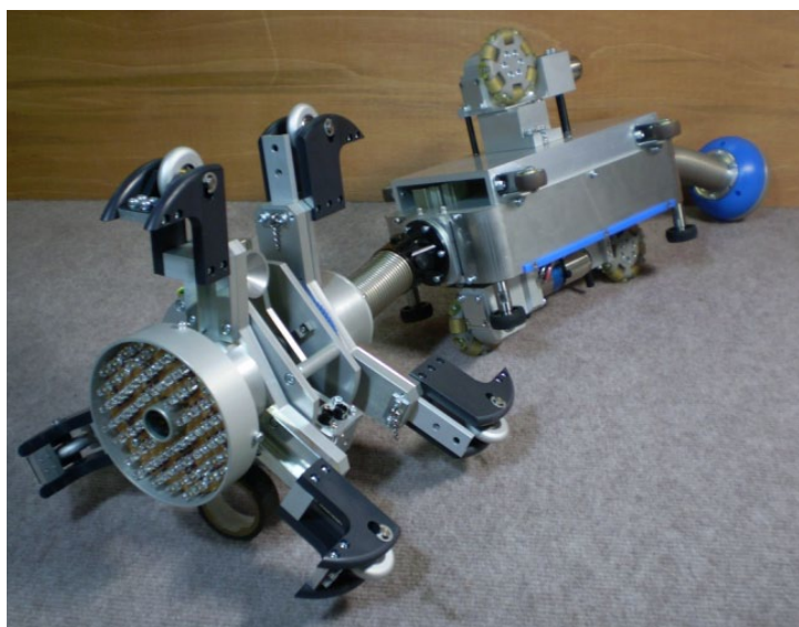
モグラ装置本体 (CCDカメラユニットと走行装置)
